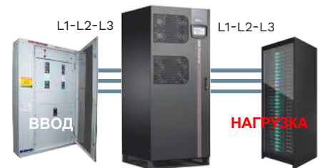
(L1-L2-L3) подключение без нейтрали
