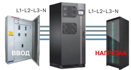
(L1-L2-L3-N) подключение с нейтралью
